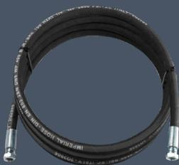
Tubería de goma SAE 100 R1AT racorada a alta presión con conexiones "H" \*\*\*(TL) con rosca BSP, especial para el suministro de ACEITE Y GASOLEO/DIESEL a alta presión. Interior en goma sintética resistente a los fl uidos hidráulicos, con refuerzo de una malla trenzada de acero tratado y recubierta de goma de alta resistencia a la abrasión y a los agentes atmosféricos.
