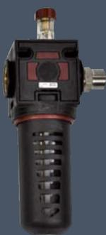
Lubricador de aceite, realiza una nebulización de una pequeña cantidad de aceite a través del flujo del aire comprimido, lubricando la parte interna de la bombas neumáticas, alargando la vida útil de las mismas. También a baja presión.
