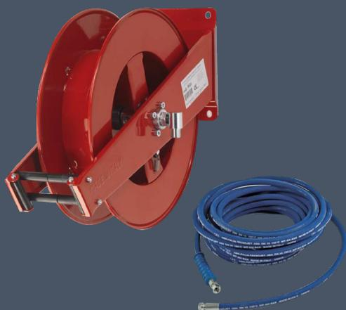
Enrollador de manguera automático de acero pintado o inoxidable AISI 304, serie Estándar, ideal para su uso en distancias máx. de 20 m con manguera de 1/2" ó hasta 25 m con manguera de 3/8". El enrollador se entrega normalmente sin manguera y puede ser utilizado con mangueras para aceite, anticongelante, grasa, aire y agua. En modelos de acero pintado las partes internas en contacto con el fluido pueden ser de acero inox, bajo pedido.
