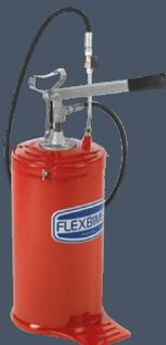
Bomba de engrase manual a palanca con depósito de 16 kg portátil, con tubo flexible de 1/4" R1AT largo 1.5m, grifo de cierre y tubo rígido con boquilla de engrase.
