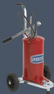
Bomba de engrase manual a palanca con depósito de 16 kg portátil, con tubo flexible de 1/4" R1AT largo 1,5 m, grifo de cierre y tubo rígido con boquilla de engrase.
