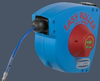
Enrollador automático carenado en plástico 15 m, (nylon + polipropileno), con soporte orientable, ideal para aplicaciones de aire comprimido y agua (temperatura -10°C hasta +60°C) completo con tubería en poliuretano. Conexión entrada aire 1/4" BSP. Presión de trabajo máx. 20 bar.
