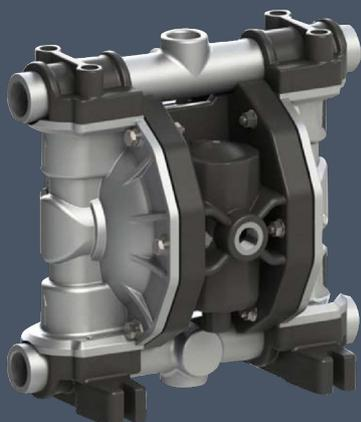
Bomba neumática de diafragma de doble membrana auto aspirante, nos permite la aspiración hasta 5 m. en altura y 9,8 en horizontal, especialmente indicadas para el trasvase de fluidos que puedan tener pequeñas partículas de hasta 4 mm art. 8320 y 7,5 mm art. 8321, fabricadas con cuerpo en PP, membranas en HYTREL+PTFE, esferas SS y juntas de VITON®. Aptas para su uso en ambientes con riesgo de explosión con certificación ATEX EXII 3/3 GD c IIB T 135°C.
