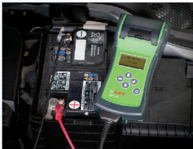
El comprobador de baterías portátil BAT 131 es adecuado para una amplia gama de aplicaciones en vehículos y normas de pruebas.
